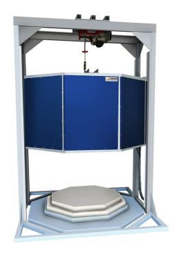
Печи данного типа отличаются от других тем, что в них процесс нагрева изделий или заготовок ведется под специальным переносным колпаком, который устанавливается на платформуплощадку. Колпак представляет собой довольно сложное устройство — футерованный «купол» со встроенными в него нагревательными элементами.
