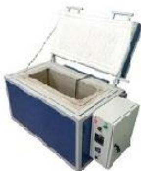
Использование соляной ванны позволяет в достаточно сжатые сроки осуществить нагрев детали под закалку либо отпуск. В большинстве случаев оборудование данного типа используется для работы со сталями, относящимися к инструментальному классу.
